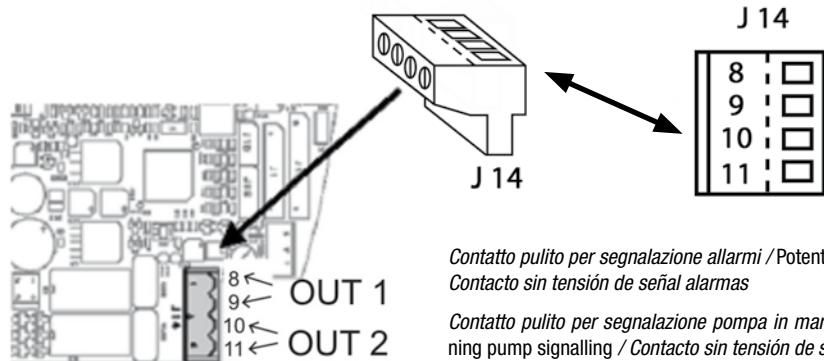
*Contatto pulito per segnalazione allarmi / Potential-free contact for alarm signalling /
