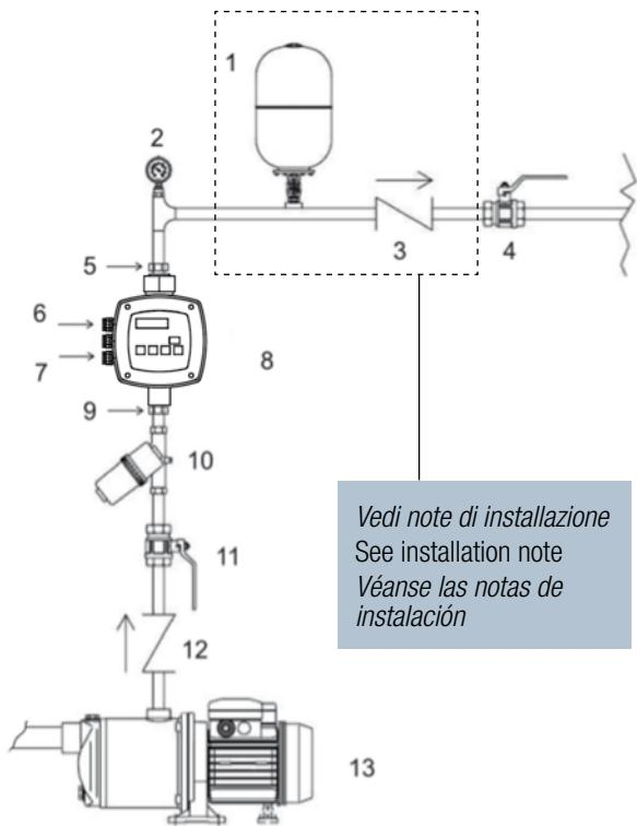
*La figura 1 mostra lo schema di un corretto impianto idraulico.*
