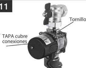
Para finalizar coloque nuevamente la tapa cubre conexiones del control automático FL-FLP y su tornillo.
