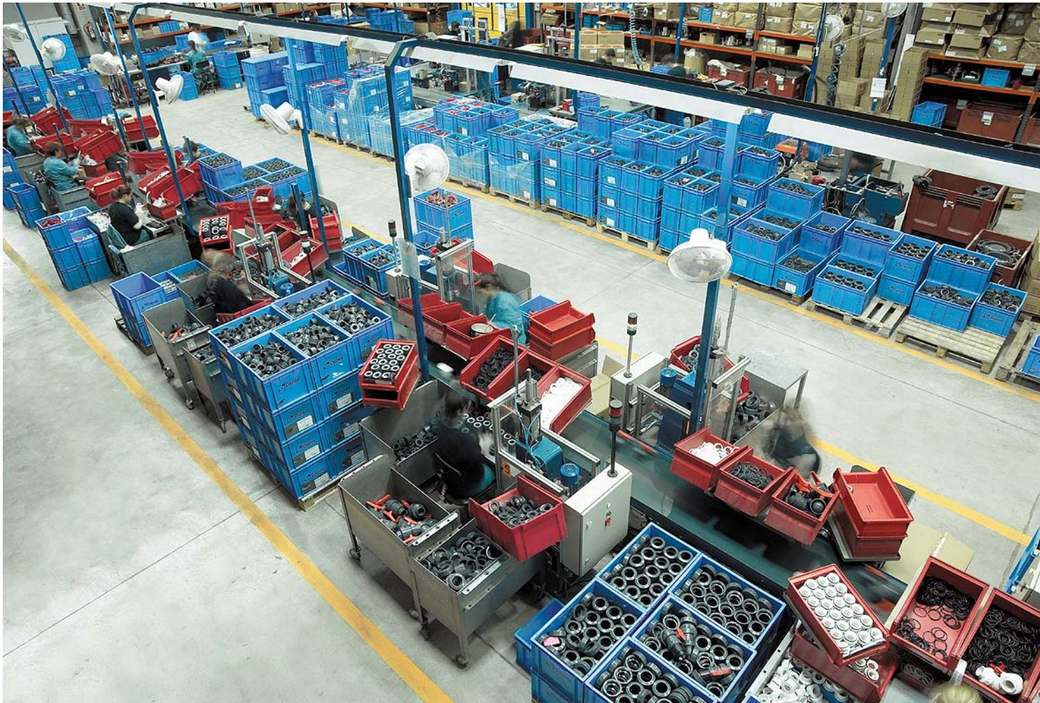
Línea de montaje semiautomática válvulas
